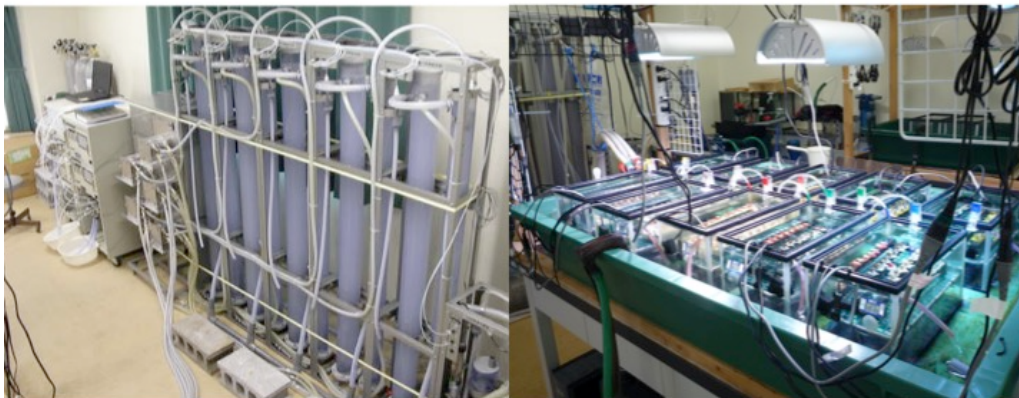
図. 精密 p\text{CO}_2 制御装置（左）とサンゴ飼育実験（右）
