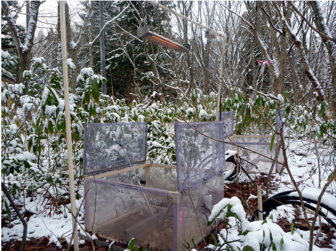
図 1. 白神山地のミズナラ林に設置した温暖化区のチャンバーとカーボンヒーター
