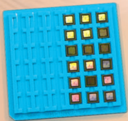
マイクロプロセッサのVLSI（ベリー・ラージ・スケール・インテグレイティッド・サーキット、大規模集積回路）を作り込んだチップ（半導体の小片）と、チップをパッケージしたもの（写真の黒色のもので、電子製品に使われるのはこの形状）
