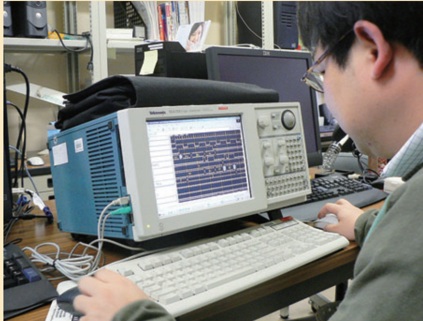
マイクロプロセッサ「HCゴリラ」の暗号化動作を検証している佐藤友暁准教授。モニターでオーディオと画像の暗号をチェック
