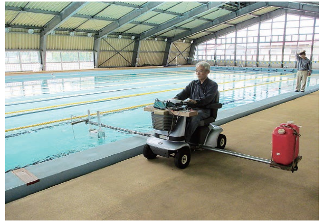
プールを利用した発電機の特性実験の様相
