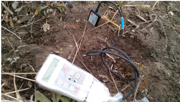
土壌塩害度測定の様子
