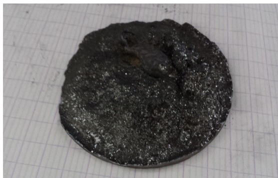
共同実験で得られた還元シリコン。 直径 70mm 程度、厚さ 8mm 程度
