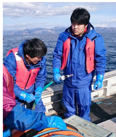
定点観測に用いる電磁流速計のメンテナンス作業とデータ確認作業の様相
