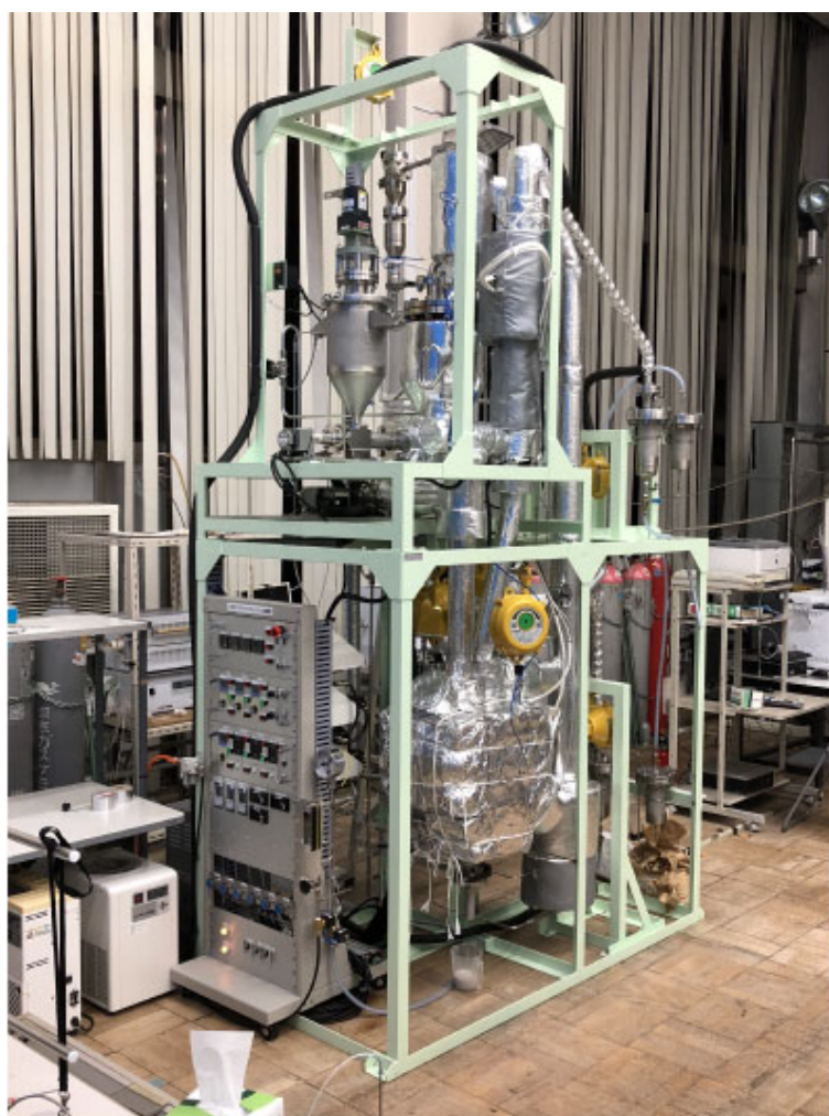
(1) 完成した分離型の小型バイオマスガス化システムデモ機の写真
