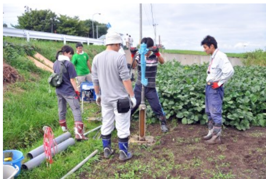
(1) 土壌ボーリング調査風景
