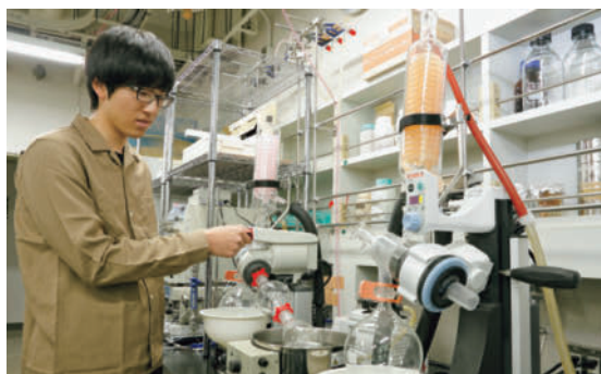
エバポレータ(減圧濃縮装置)で有機溶媒を取り除きます。有機化学実験の必需品です。
