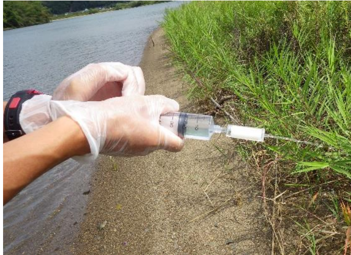
図 1. 採水した河川水をろ過している様子。注射筒の先についている白い物が、フィルターの入ったカートリッジ。
