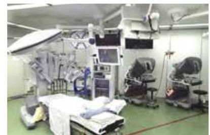
遠隔操作型内視鏡下手術システム「ダ・ヴィンチSi」
