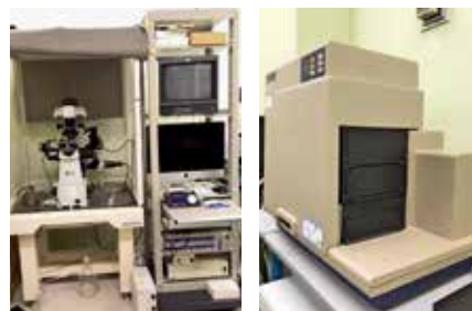
写真6 味覚受容体の機能を解析するための装置 イオンチャネルの活動を観察するパッチクランプのセット（左）と、カルシウムイメージングなどに使用できるマルチモードマイクロプレートリーダー（右）。
