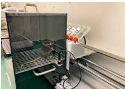
写真3 リック（舐め行動）テストの様子 香辛料成分の溶液を舐める回数を測定している様子。16種類の溶液を連続で測定することができます。
