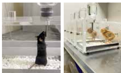
写真4 呼吸ガス分析装置 チャンバー内に充満したマウス（左）やニワトリヒナ（右）の呼吸を採取して代謝状態を測定することができます。
