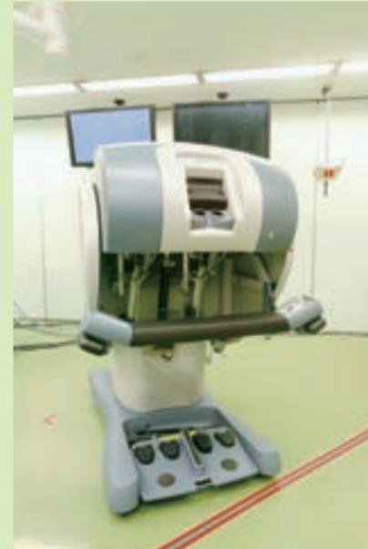
入力装置「コンソール」。3Dのモニター画面を見ながら、コントローラーで操作。ペダルを踏めば、メスに電気が流れる
