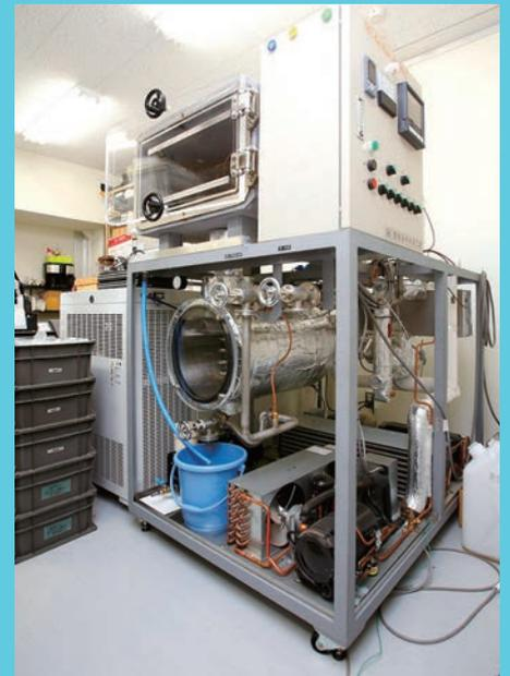
真空凍結乾燥機。急速に凍結し、さらに減圧して真空状態にすることで水分を昇華させ、そのままのかたちを残す
