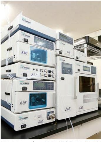
採取したサンプルから機能性成分を分離・分析するための超高速液体クロマトグラフィ装置
