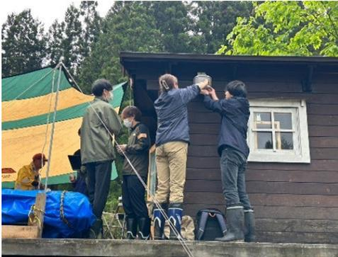
データロガー(気温気圧湿度計)の設置
