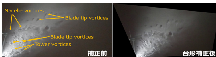
20kW風車の後流可視化像 撮影画像（左）、歪ならびに画角・レンズ歪み補正像（右）。
